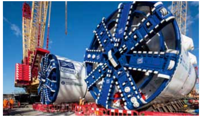
Fig. 9. Tunnel boring machine from Herrenknecht Bild 9. Tunnelbohrmaschine der Fa. Herrenknecht Source/Quelle Crossrail 2015 (6)
