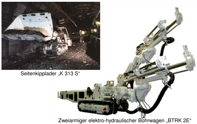
Fig. 3. Roadheading system – standardised shotfired drivage Bild 3. Vortriebstechnik – standardisierter Sprengvortrieb
