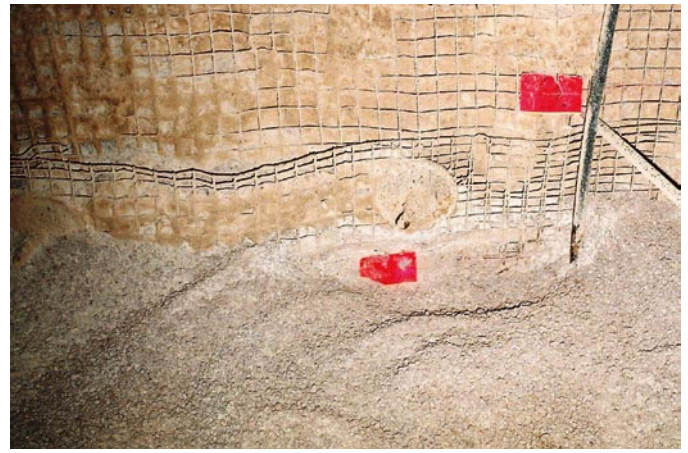
Fig. 10. Binary mixture of bentonite pellets and sand Bild 10. Binärgemisch aus Bentonitpellets und Sand
