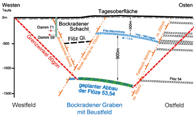
Fig. 1. Coal extraction in the Bockraden Trench Bild 1. Abbausituation im Bockradener Graben
