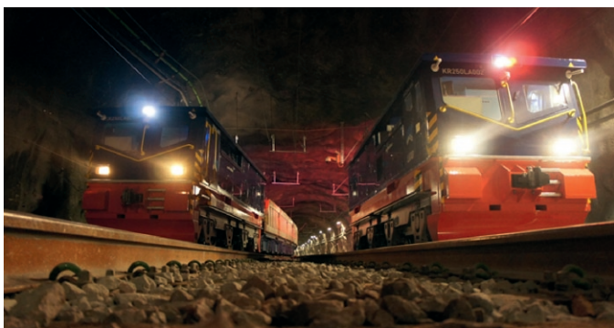
Fig. 2. Example of Schalke's full automated rail haulage system at LKAB Bild 2. Beispiel des vollautomatischen Schalke-Zugfördersystems bei LKAB
