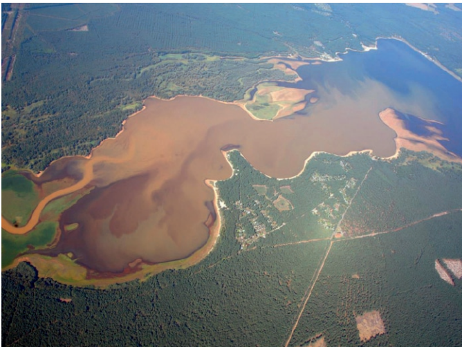
Fig. 5. Iron load carried into the Spremberg reservoir. Bild 5. Eiseneintrag in die Talsperre Spremberg. Photo / Foto: Rauhut, 2013
