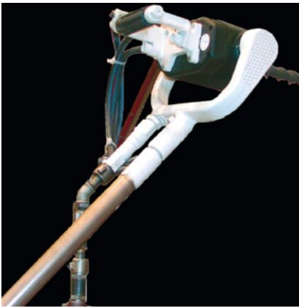
Fig. 5. Compressed-air rotary drill with pusher leg Bild 5. Druckluftdrehbohrmaschine mit Bohrsäule Photo / Foto: Hazemag & EPR GmbH
