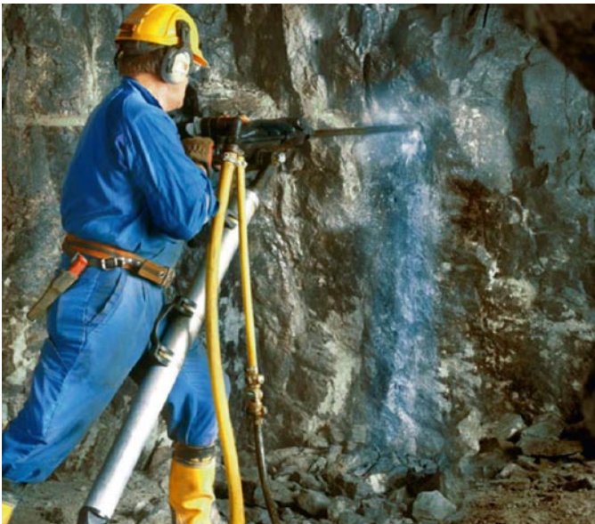
Fig. 1. The 'Swedish method': one man, one machine Bild 1. Die „Schwedische Methode“: ein Mann pro Bohrhammer Photo / Foto: Atlas Copco
