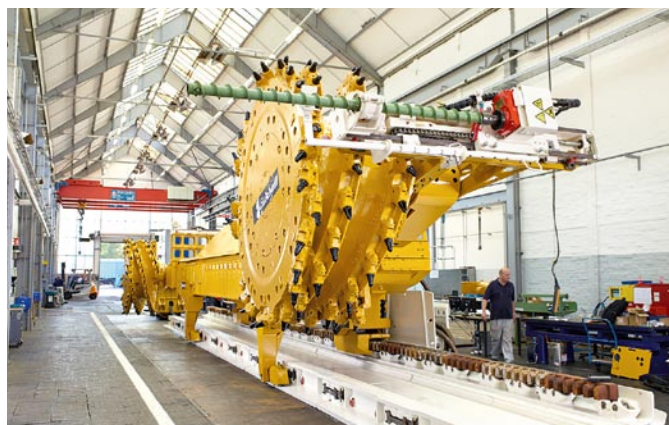
Fig. 7. Modified drum shearer SL 750 of Eickhoff Bergbautechnik GmbH Bild 7. Modifizierter Walzenschrämlader SL 750 der Eickhoff Bergbautechnik GmbH. Source / Quelle: RAG AG
