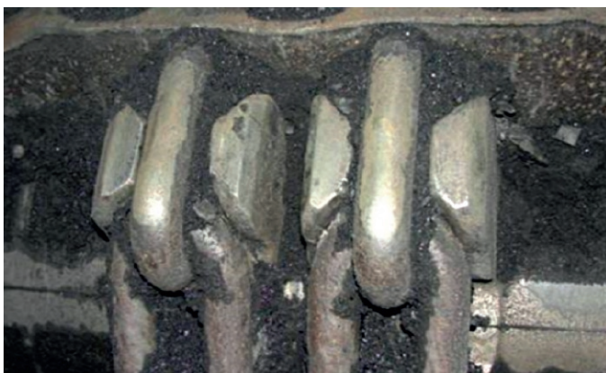
Fig. 10. Coal fines adhering to the chain links. (10) Bild 10. Kohleanbackungen an Kettengliedern. (10)
