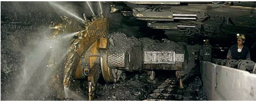
Fig. 11. Spray system operating on a shearer loader. Bild 11. Bedüsungssystem Walzenlader. Photo/Foto: BW Schlägel und Eisen (12)
