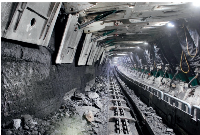
Fig. 1. Twin-strand inboard chain conveyor on a longwall face. Bild 1. Doppelmittelkettenförderer im Strebbau. Photo/Foto: Mediajif for PG Silesia
