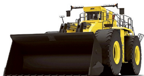
Fig. 2. Wheel loader with 53 m 3 bucket. Bild 2. Radlader Schaufelgröße 53 m 3 . Photo/Foto: Joy Global
