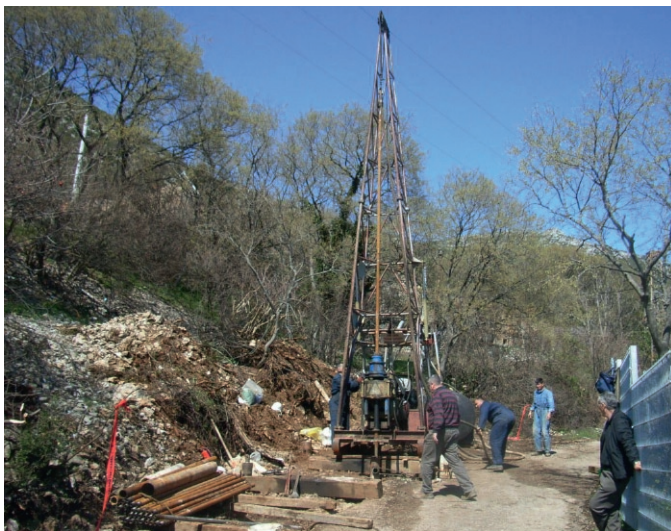
Fig. 3. Drilling device JANEZ-600 at drillhole B 43 (4). Bild 3. Bohrgerät JANEZ-600 am Bohrloch B 43 (4).
