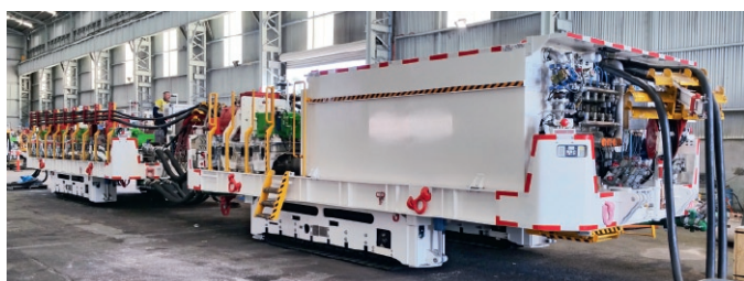
Fig. 8. Pump station on platform with crawler tracks. Bild 8. Pumpenstation auf Plattform mit Raupenfahrwerk.
