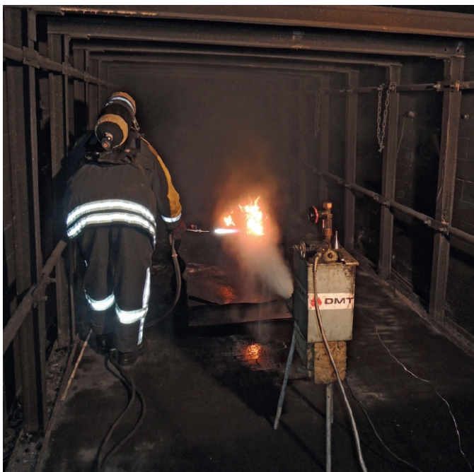
Fig. 2. Spray ignition test according to DIN EN ISO 15029-1. Liquid dispensed under high pressure is ignited with a welding torch. Bild 2. Sprühstrahlzündprüfung nach DIN EN ISO 15029-1. Mit einer Schweißbrennerflamme wird versucht die unter Druck ausströmende Hydraulikflüssigkeit zu entzünden. Photo/Foto: DMT
