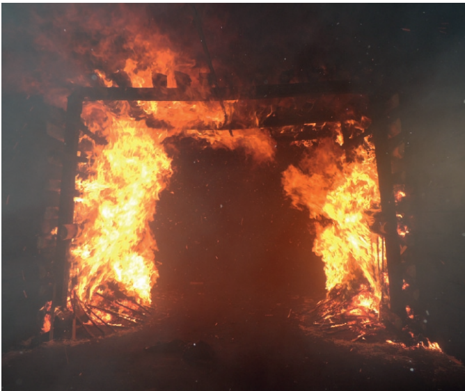
Fig. 7. Testing of plastic pipes mounted under the roof according to DIN 22100-5. The fire's approximate fire output is 3,3 MW. Bild 7. Prüfung von an der Firste befestigten Kunststoffrohren nach DIN 22100-5. Die Wärmeleistung des Feuers beträgt ca. 3,3 MW.
