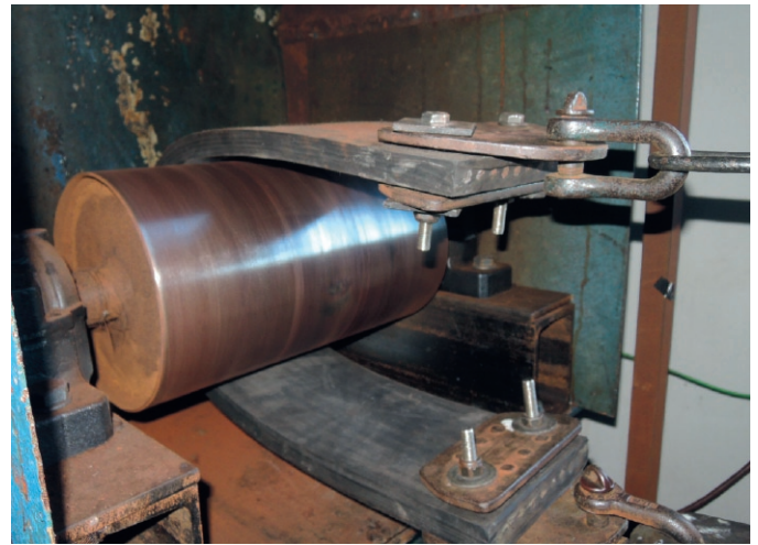
Fig. 5. The so called drum friction test: A conveyor belt is firmly fixed while the drum is rotating with (200\pm 5)\text{min}^{-1} . Bild 5. Der so genannte Reibtrommeltest: Ein Fördergurt wird fest eingespannt während sich die Trommel mit (200\pm 5)\text{min}^{-1} dreht.
