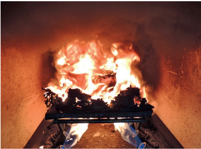
Fig. 4. Testing of a conveyor belt according to DIN EN 12881-1, method C in a laboratory scale fire testing tunnel with a six parts burner. Bild 4. Prüfung eines Fördergurts gemäß DIN EN 12881-1, Verfahren C im sogenannten Laborbrandstollen mit einem sechsteiligen Brenner.
