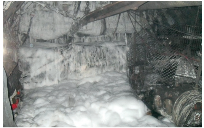
Fig. 9. In order to reduce the oxygen-reactivity of the coal the goaf is covered with relatively „dry“ foam. Bild 9. Aus einer abgeworfenen Abbaubegleitstrecke und dem Alten Mann austretender Trockenschaum.
