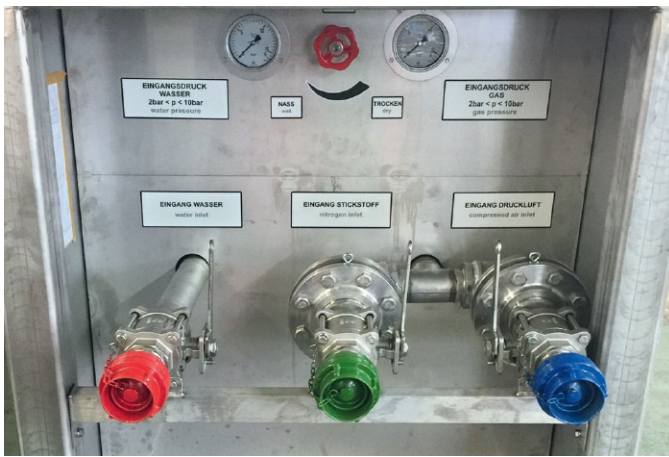
Fig. 6. Control panel and inlet connectors for water, nitrogen and air. Bild 6. Bedienfeld und Maschineneingänge für Wasser, Stickstoff und Druckluft.
