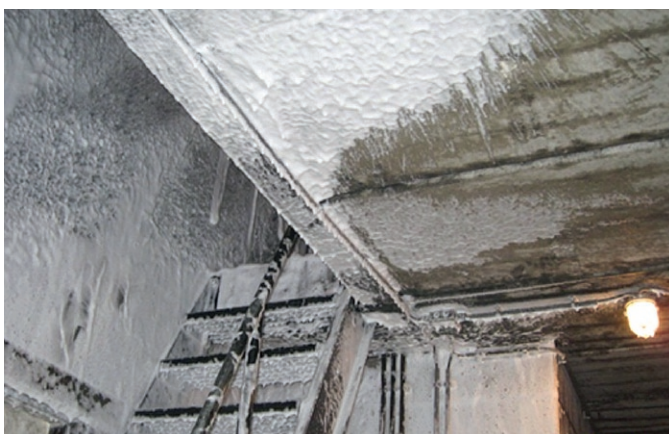
Fig. 3. Result of the foam's adhesive properties in a practical demonstration. Bild 3. Ergebnis eines Adhäsionsversuchs.
