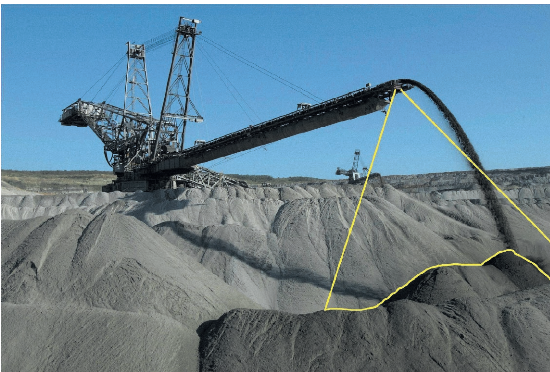
Fig. 4. Scanning the discharge of the spreader. Bild 4. Scannen des Materialabwurfs am Absetzer.
