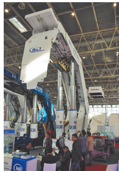
Fig. 2. 8 m roof support at China Coal Show. Bild 2. 8 m-Schildausbau auf der China Coal Show. Source/Quelle: Caterpillar
