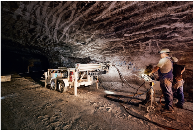
Fig. 3. Wheel-mounted trailer with drill rig. Bild 3. Radmobiler Anhänger mit Bohrgerät. Source/Quelle: HAZEMAG
