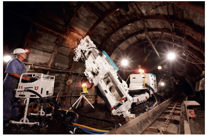
Fig. 4. HLH 220 crawler-mounted drilling machine. Bild 4. Raupenmobiles Bohrgerät HLH 220. Source/Quelle: HAZEMAG
