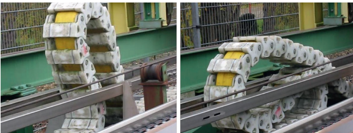
Fig. 7/8. Flat cable on the chain test rig. // Bild 7/8. Flachleitung im Kettenprüfstand. Source/Quelle: Prysmian
