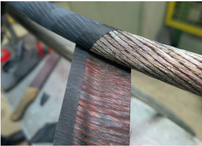
Fig. 6. The components are wrapped in special tapes and the cable sheath is coated with a fleece. Bild 6. Die Komponenten sind mit speziellen Bändern umwickelt und der Mantel der Leitung wurde mit einem Flies verklebt. Source/Quelle: Prysmian
