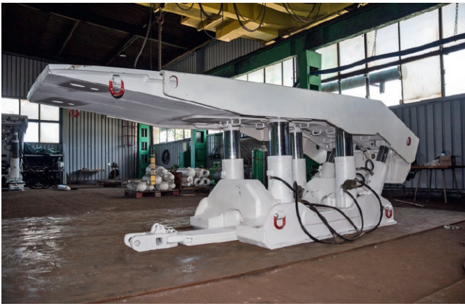
Fig. 8. Prototype of the powered support section of a new type. Bild 8. Prototyp des vollmechanischen Ausbaus neuen Typs.
