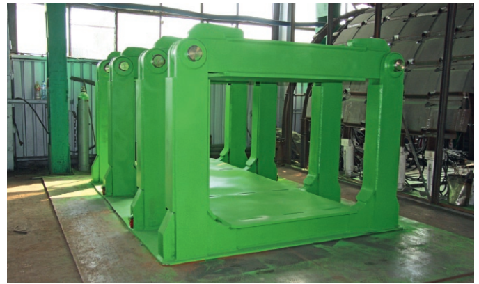
Fig. 9. Overview of a work-station frame for testing a single section powered support. Bild 9. Prüfrahmen zum Test einer einzelnen Ausbaueinheit.
