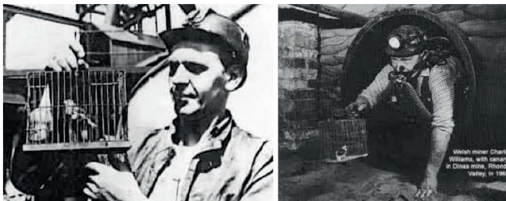
Fig. 1. Canary gas detector. Bild 1. Kanarienvögel als Warngerät für schädliche Gase. Photo/Foto: Stewart
