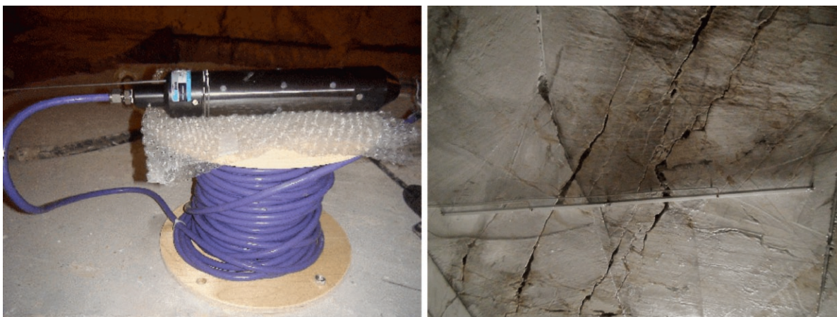
Fig. 6. VW biaxial stressmeter (left) and horizontal EL-beam gauge (right). Bild 6. Biaxialer Spannungsmesser (links) und horizontales Dehnungsmessgerät (rechts).
