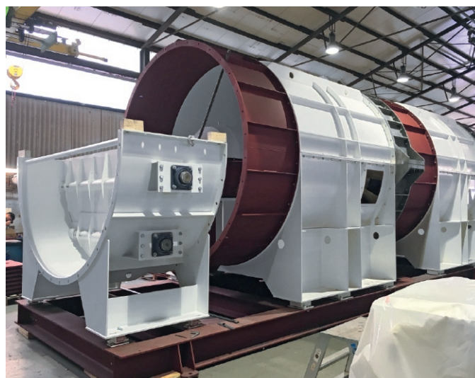
Fig. 3. Modular designed main mine fan during the manufacturing process. // Bild 3. Modular aufgebauter Hauptgrubenlüfter während des Fertigungsprozesses. Source/Quelle: CFT
