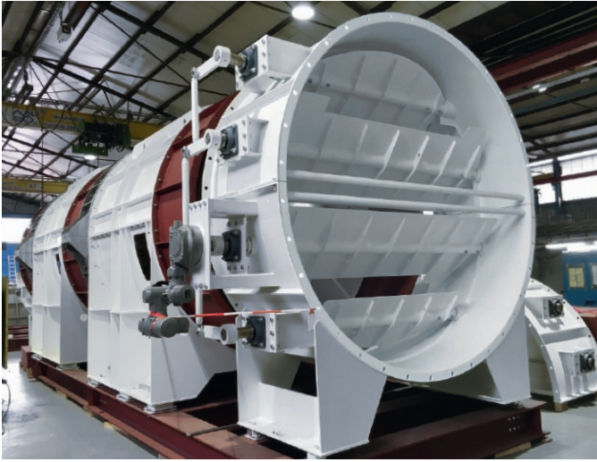
Fig. 4. Main mine fan with electrically actuated damper. Bild 4. Hauptgrubenlüfter mit elektrischer Klappensteuerung. Source/Quelle: CFT
