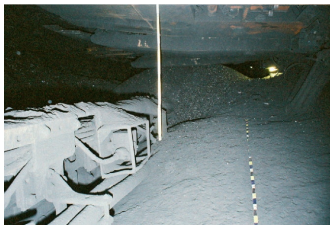
Fig. 3. Result of a gas-coal outbreak in a working face. Bild 3. Gas-Kohlenausbruch im Streb.
