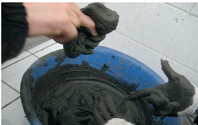
Fig. 12. Cemented copper tailings paste. Bild 12. Zementschlamm aus der Kupfererzaufbereitung.
