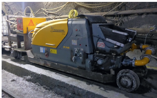
Fig. 9. Concrete pump Putzmeister P 715 SE on rail car. Bild 9. Betonpumpe Putzmeister P 715 SE auf dem Gleiswagen. Photo/Foto: www.moertelmaschinen.de
