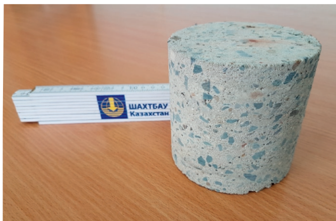
Fig. 11. Concrete core with 100 mm diameter and 100 mm in height prepared for concrete test – taken from shotcrete shell produced underground. // Bild 11. Für die Betonprüfung vorbereiteter Betonkern mit 100 mm Durchmesser und 100 mm Höhe. Photo/Foto: SBK
