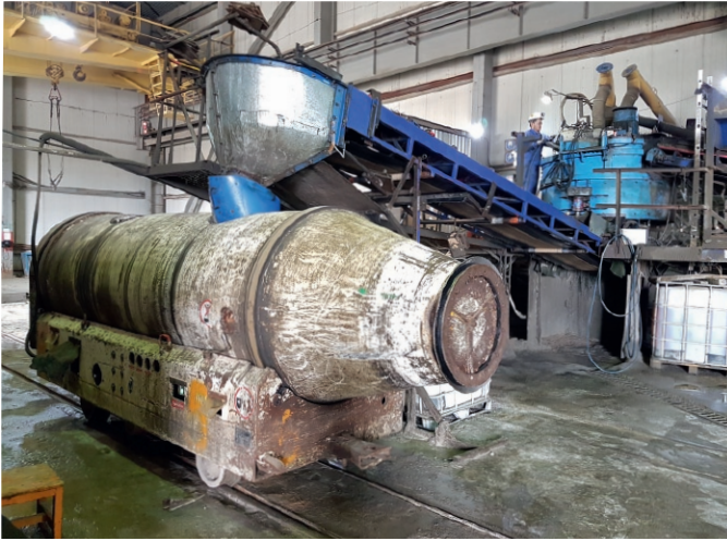
Fig. 10. Concrete remixer being loaded with fibre reinforced concrete. Bild 10. Betonnachmischer beim Beladen mit faserbewehrtem Beton. Photo/Foto: SBK
