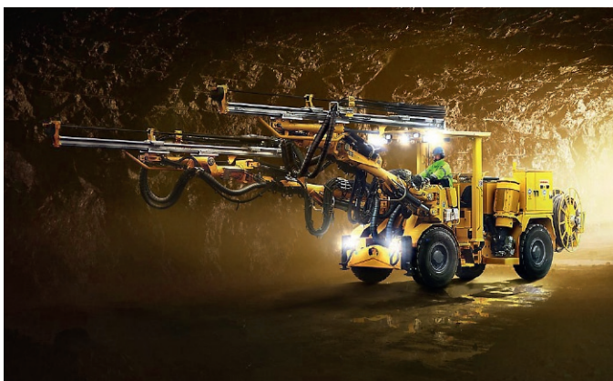
Fig. 2. Atlas Copco Epiroc Rocket Boomer 282 face drilling rig. Bild 2. Bohrwagen Atlas Copco Epiroc Rocket Boomer 282. Source/Quelle: www.epiroc.com
