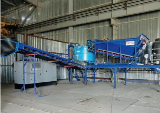
Fig. 6. Concrete mixing plant Type HA MP 1125/750 SM, Hartmann. Bild 6. Betonmischanlage Typ HA MP 1125/750 SM, Firma Hartmann. Photo/Foto: www.hartmann-betonmischanlagen.de
