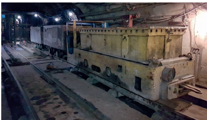
Fig. 4. Locomotives and mine cars deployed at the Donskoy GOK mine for transporting loaded muck. Bild 4. Die von Donskoy GOK für den Transport des geladenen Haufwerks eingesetzten Lokomotiven und Förderwagen. Photo/Foto: SBK
