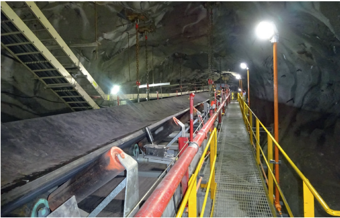
Fig. 2. TAKRAF's underground material handling system in Indonesia delivering 8,000 t/h of primary crushed ore. Bild 2. TAKRAF's Untertage Massengutumschlagssystem in Indonesien besitzt eine Förderkapazität von 8.000 t/h Eisenerz. Photo/Foto: TAKRAF
