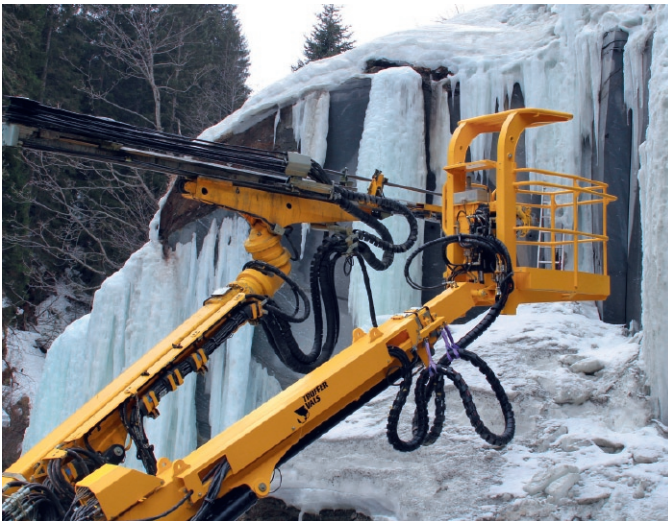
Fig. 3. Boomer E1C-DH equipped with a BUT 45 and service basket. Bild 3. Boomer E1C-DH mit BUT 45 und Serviceplattform. Photo/Foto: Epiroc
