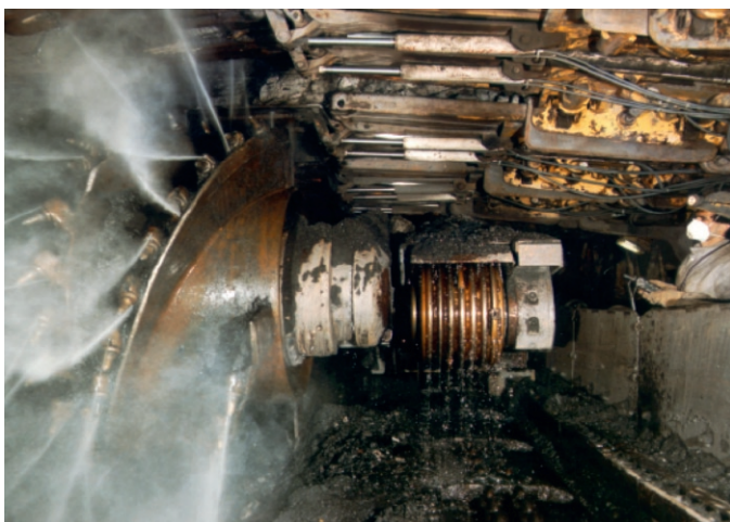
Fig. 7. Dust suppression provided by spray jets on the shearer drum. Bild 7. Staubbekämpfung mit Bedüsung der Schneidwalzen.
