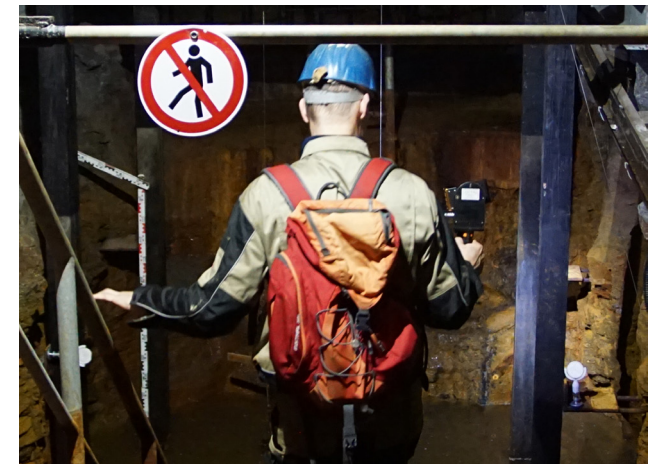
Moderne Scannertechnik im Altbergbau
