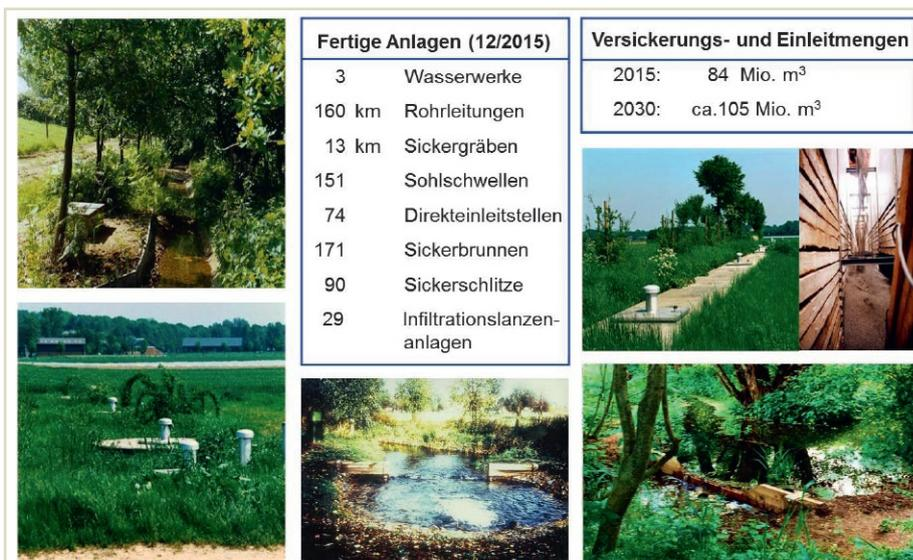
Fig. 6. Measures aimed at maintaining groundwater levels and surface water bodies in groundwater-dependent wetlands. // Bild 6. Maßnahmen zum Erhalt des Grundwasserstands und von Oberflächengewässern in grundwasserabhängigen Feuchtgebieten. Source/Quelle: RWE Power AG
