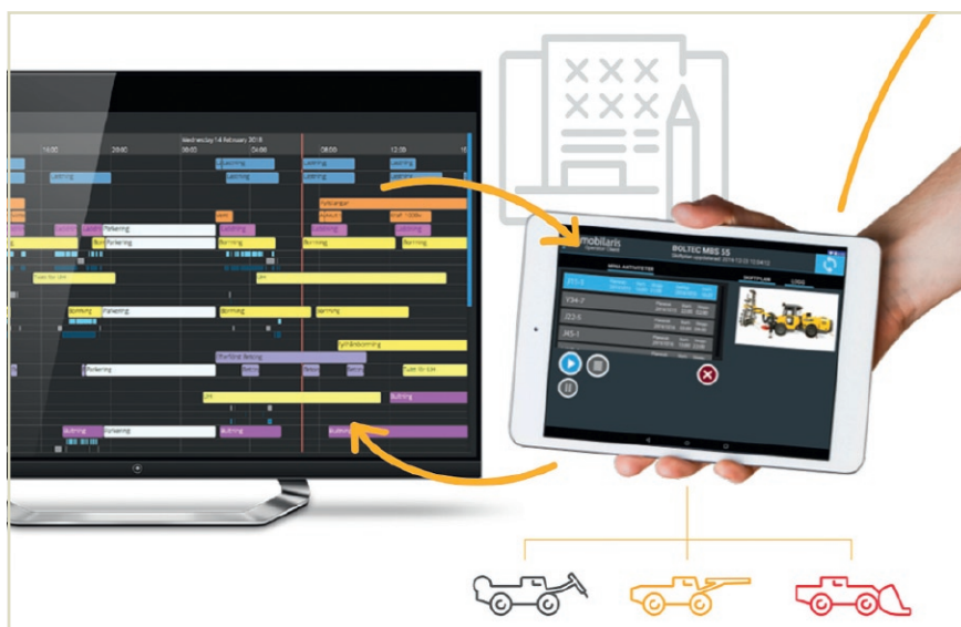
Fig. 4. The Epiroc Control Tower connects the planning cycle, order assignment, remote maintenance/ servicing, machine control and data processing unit. Bild 4. Der Control Tower von Epiroc verbindet den Planungszyklus, die Auftragszuweisung, die Remote-Instandhaltung/Wartung, die Maschinensteuerung sowie die Datenverarbeitungseinheit miteinander. Source/Quelle: Epiroc
