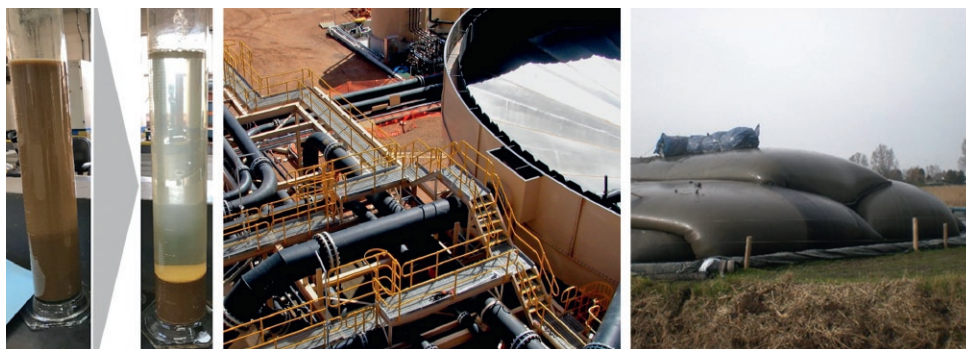
Fig. 5. Dewatering of tailings: experiment (8), plant (9), geotextiles (10). Bild 5. Entwässerung: Experimentell (8), Aufbereitungsanlage (9), Geotextilien (10).
