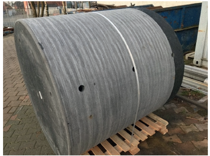
Fig. 6. Load distribution cylinder. // Bild 6. Lastverteilungskörper. Photo/Foto: RAG
