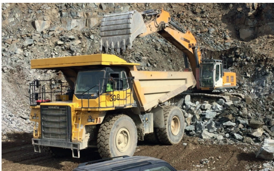
Fig. 2. Exemplary loading cycle between hydraulic excavator and dump truck. // Bild 2. Beispielhafter Ladezyklus zwischen Hydraulikbagger und SKW. Photo/Foto: talpasolutions
