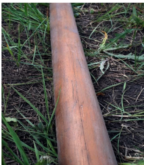
Fig. 5. TENAX-LUMEN after one year of use (left). The surface shows the usual abrasion. // Bild 5. TENAX-LUMEN nach einjährigem Einsatz (links). Die Oberfläche zeigt den üblichen Abrieb. Photo/Foto: Prysmian Group
