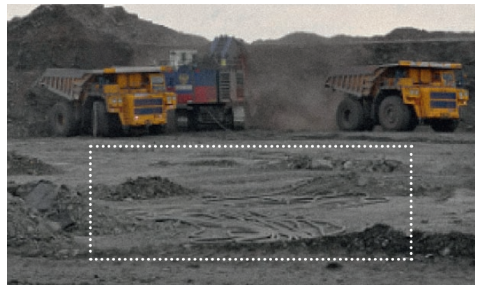
Fig. 1. Typical scenario in open-pit mining: The cables are scattered over the mine's entire terrain // Bild 1. Typisches Szenario im Tagebau: Die Kabel sind über das gesamte Terrain des Bergwerks verstreut. Photo/Foto: Prysmian Group
