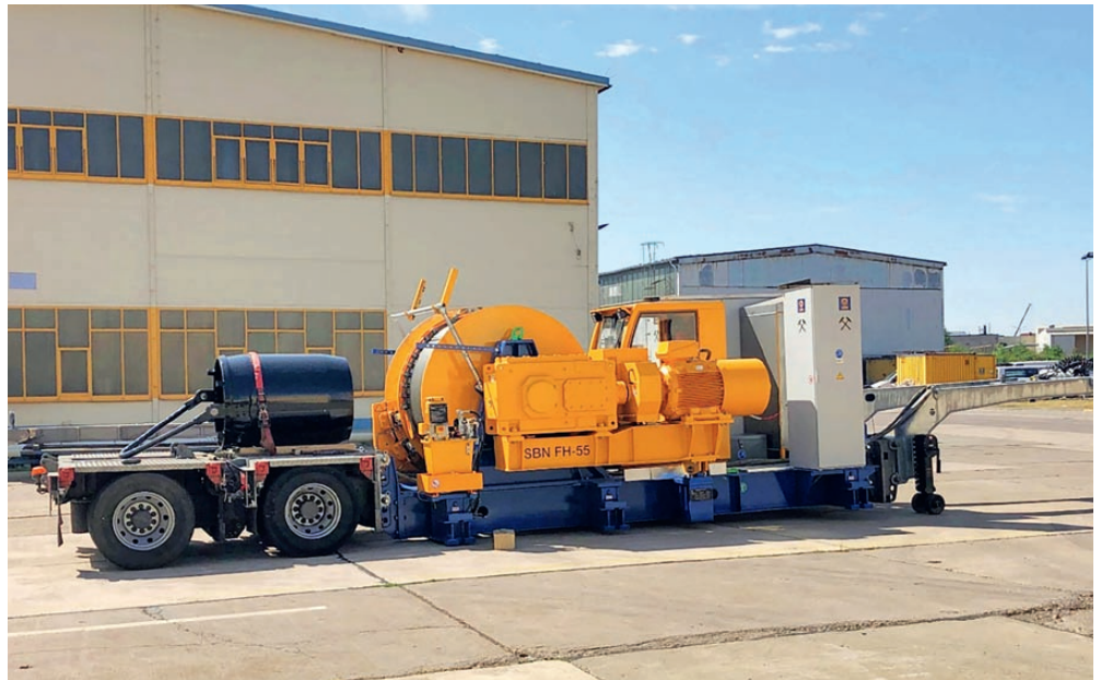
Fig. 6. The winder can be transported on public roads on a modular chassis. Bild 6. Auf einem Modulfahrwerk kann der Haspel im öffentlichen Straßenverkehr transportiert werden. Photo/Foto: SBN
