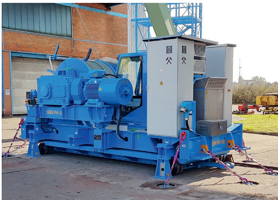
Fig. 5. Plate trolley for moving the winder in-house. // Bild 5. Plattenwagen für das innerbetriebliche Umsetzen des Haspels. Photo/Foto: SBN
