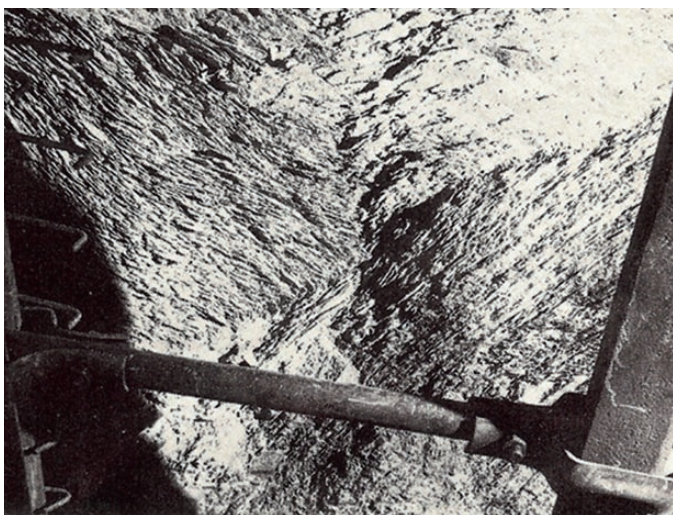
Fig. 5. Pressure relief structures in the wall of the cavity of a gas/sandstone outburst (9). // Bild 5. Druckentlastungsstrukturen in der Wandung des Hohlraums eines Gas/Sandstein-Ausbruchs (9).
