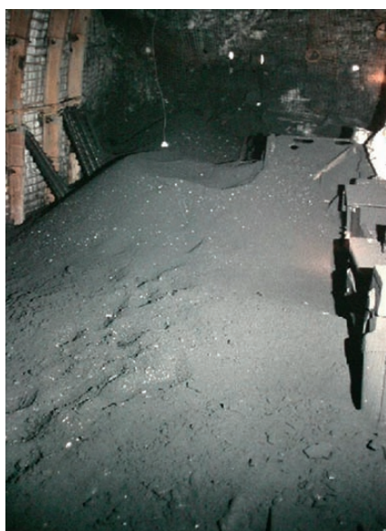
Fig. 1. Powdered coal after a gas/coal-outburst in a roadway. Bild 1. Pulverisierte Kohle nach einem Gas/Kohlen-Ausbruch in einer Strecke. Photo/Foto: DMT
