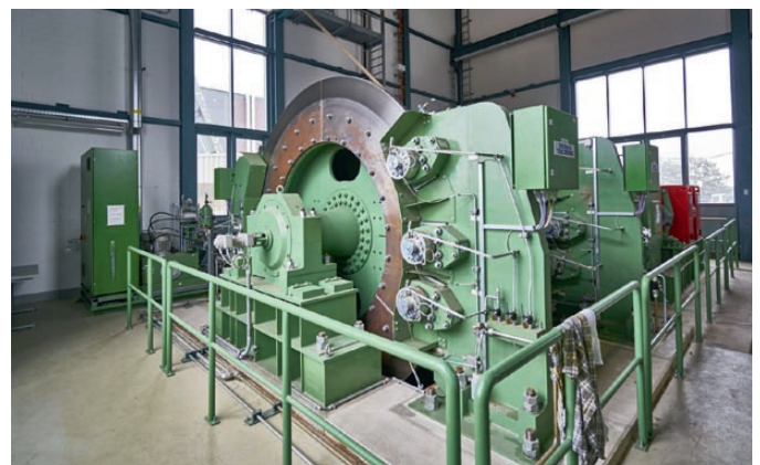
Fig. 5. Single Rope Winder Konrad 1 shaft – southern strang. Bild 5. Einseiltrommelförderhaspel Konrad 1-Süd. Photo/Foto: BGE
