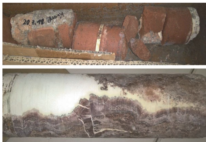
Fig. 8. Checking the injection area through core drilling. // Bild 8. Kontrolle der Injektionen durch Kernbohrungen. Photos/Fotos: Redpath Deilmann
