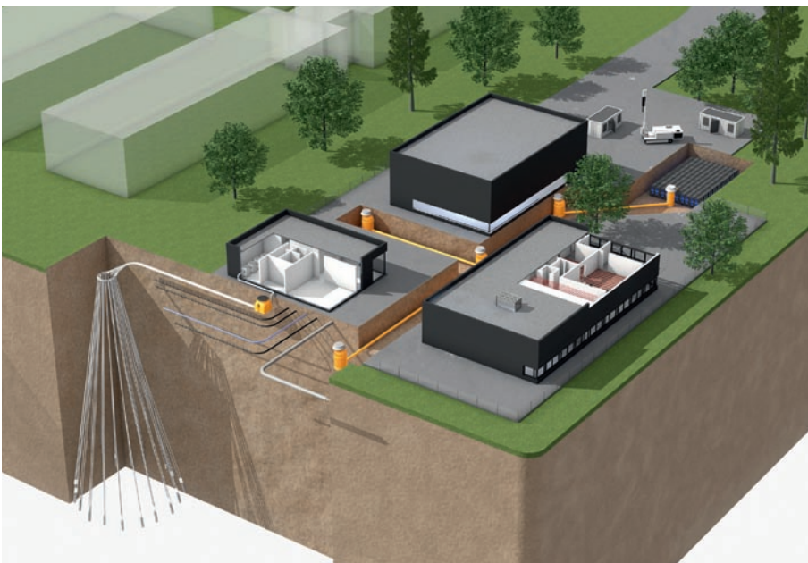
Fig. 7. Fraunhofer IEG is setting a good example at its location in Bochum, which it has developed with shallow geothermal energy which covers its heating and cooling requirements. In the future, it wants to explore the potential for deep geothermal energy in the TRUDI demonstrator. Bild 7. Mit gutem Beispiel voran geht das Fraunhofer IEG an seinem Standort in Bochum, welches es mit flacher Geothermie erschlossen hat und so seinen Wärme- und Kältebedarf deckt. In Zukunft will es im Reallabor TRUDI auch das Potential für die tiefe Geothermie erkunden. Source/Quelle: Fraunhofer IEG
