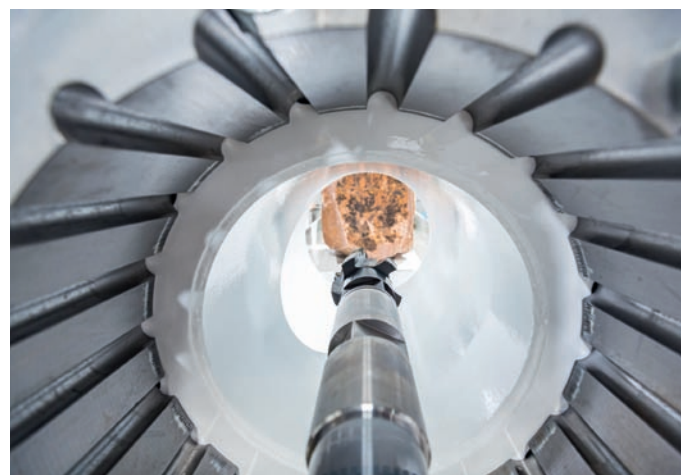
Fig. 4. At Fraunhofer IEG laboratory the match.BOGS equipment focuses on new drilling techniques and processes in underground geothermal reservoirs under real conditions. // Bild 4. Neue Bohrtechniken und Prozesse im Reservoir unter den realen Bedingungen im Untergrund nimmt die Anlage match.BOGS im Labor des Fraunhofer IEG in den Fokus. Photo/Foto: S. Kreklau/Fraunhofer IEG
