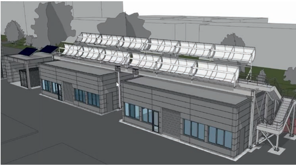
Fig. 6. Solar collectors: Old hard coal mines in the Ruhr area could in future serve as heat storage for supply of business and households. The heat collected with solar collectors in summer is stored in the mine water and can be utilized within the district heating during the winter. Bild 6. Sonnenkollektoren: Die alten Steinkohlenbergwerke des Ruhrgebiets könnten in Zukunft als Wärmespeicher für die Versorgung von Gewerbe und Haushalten dienen. Die mit Sonnenkollektoren im Sommer eingesammelte Wärme wird im Grubenwasser gespeichert und kann im Winter in die Wärmenetze eingespeist werden. Source/Quelle: Fraunhofer IEG
