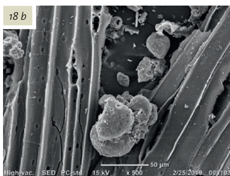
Fig. 18 a – b. SEM images of Nalaikh cyclon ash (scales: 200 µm – 50 µm). Bild 18 a – b. REM-Bilder der Nalaikh Asche aus dem Fliehkraftabscheider (200 µm – 50 µm). Source/Quelle: MFST
