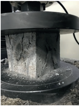
Fig. 9. Vertical cracks. Bild 9. Vertikale Risse. Photo/Foto: GMIT/DMHT
