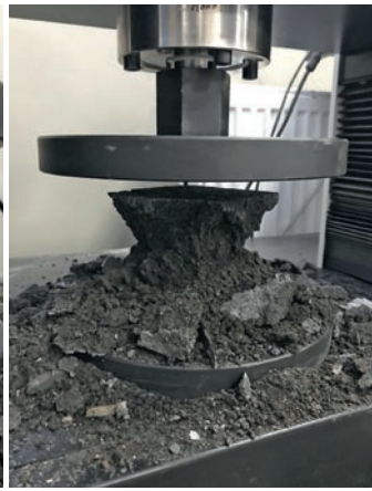
Fig. 10. Residual block core. Bild 10. Restlicher Blockkern. Photo/Foto: GMIT/DMHT
