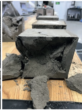
Fig. 11. Fracture pattern. Bild 11. Rissmuster. Photo/Foto: GMIT/DMHT
