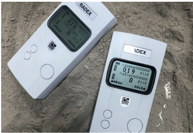
Fig. 8. Radiation meters at GMIT Process Laboratory. // Bild 8. Strahlungsmessgeräte im Prozesslabor der DMHT. Photo/Foto: GMIT/DMHT
