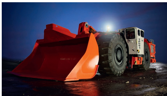
Fig. 6. Electrically-powered LH 625iE mobile loader with 25 t payload capacity. // Bild 6. Elektrisch betriebener Fahrlader LH 625iE mit 25 t Transportkapazität. Photo/Foto: Sandvik
