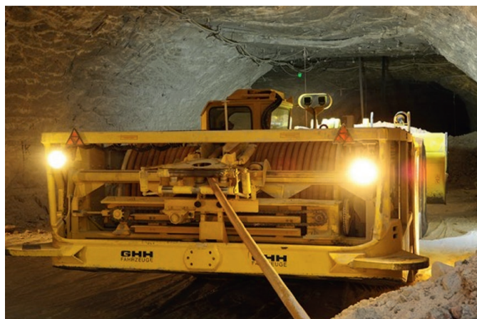
Fig. 3. Type LF 21HE electric loader with cable reel and 21 t payload capacity. // Bild 3. E-Lader mit Kabeltrommel LF 21HE mit 21 t Transportkapazität. Photo/Foto: GHH
