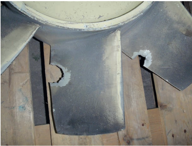
Fig. 4. Damage to the impeller. // Bild 4. Flügelradschaden. Photo/Foto: Korfmann
