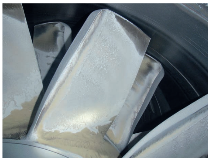
Fig. 7. Abrasion at the blade tips. // Bild 7. Abrieb an den Flügelspitzen. Photo/Foto: Korfmann
