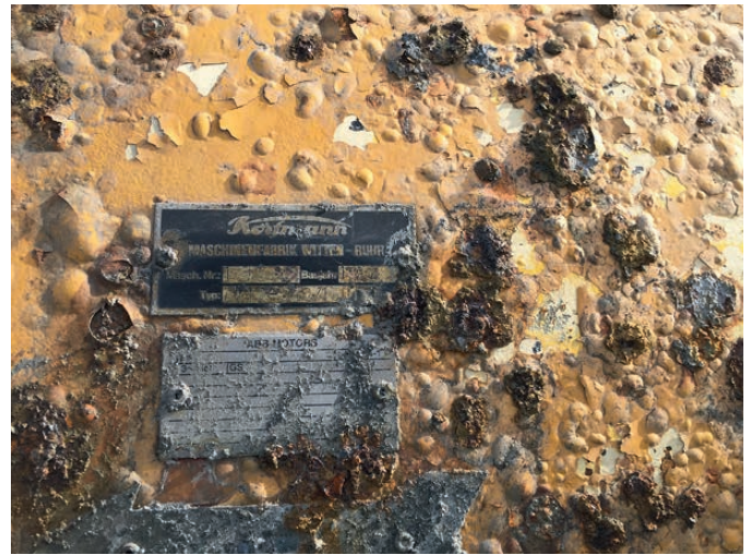
Fig. 13. Surface corrosion. // Bild 13. Oberflächenkorrosion. Photo/Foto: Korfmann
