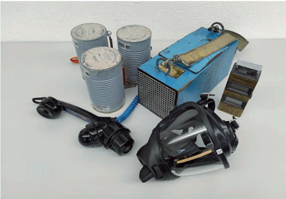
Fig. 1. Mine rescue telephone system I made by Funke + Huster Fernsig/Becker and electronic psychrometer BTS 19n made by Seba-Dynatronik. // Bild 1. Grubenwehrtelefonsystem I der Firmen Funke + Huster Fernsig/Becker und elektronisches Psychrometer BTS 19n der Firma Seba Dynatronik. Photos/Fotos: BG RCI
