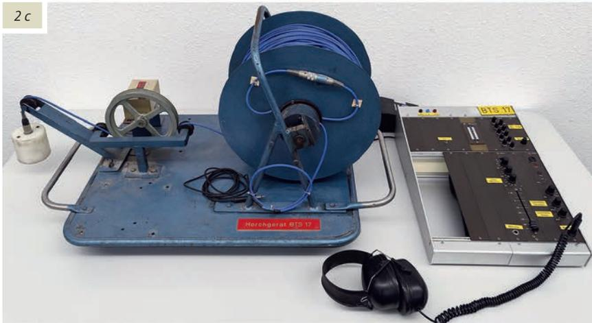
Fig. 2 a–c. Sound detector type WBK II/75, drill hole intercom type BTS 31, shaft microphone type BTS 17. Bild 2 a–c. Bergbau-Horchgerät Typ WBK II/75, Bohrloch-Wechselsprechanlage Typ BTS 31, Schachtmikrofon Typ BTS 17. Photos/Fotos: BG RCI
