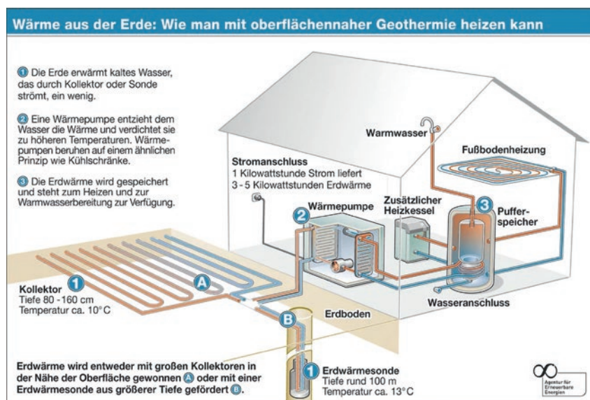
Fig. 5. Functionality of near-surface geothermal energy (10). Bild 5. Funktionsweise der oberflächennahen Geothermie (10).
