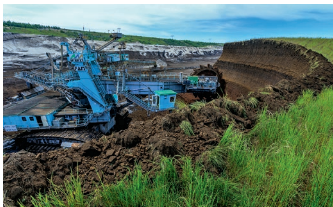
Fig. 8. Bucket-wheel excavator in MIBRAG's open-pit mine Vereinigtes Schleenhain. // Bild 8. Schaufelradbagger im Tagebau Vereinigtes Schleenhain der MIBRAG. Photo/Foto: MIBRAG, © Rainer Weisflog
