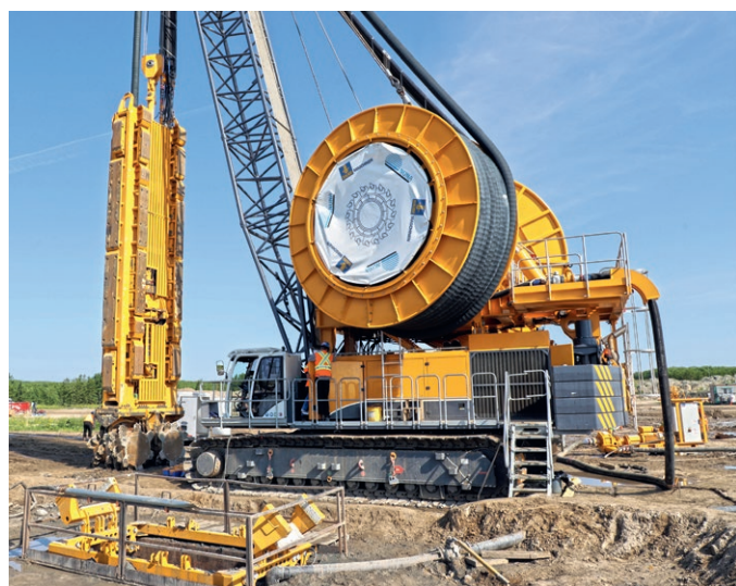
Fig. 3. Trench cutter system for bulk sampling to 250 m depth at Falcon Diamond Project in Canada. // Bild 3. Schlitzwandfräse für die Entnahme von großvolumigen Proben in 250 m Tiefe auf dem Falcon-Diamantenprojekt in Kanada. Photo/Foto: BAUER Maschinen GmbH
