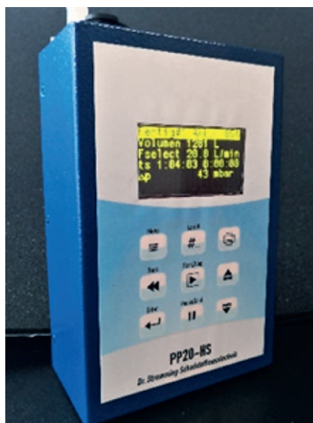
Fig. 1. PP20-HS battery-operated pump for the PGP20 – also suitable for 10 l/min systems. Bild 1. Akkupumpe PP20-HS des PGP20, auch für 10 l/min einsetzbar. Photo/Foto: IFA/Dr. Stremming Schadstoffmesstechnik
