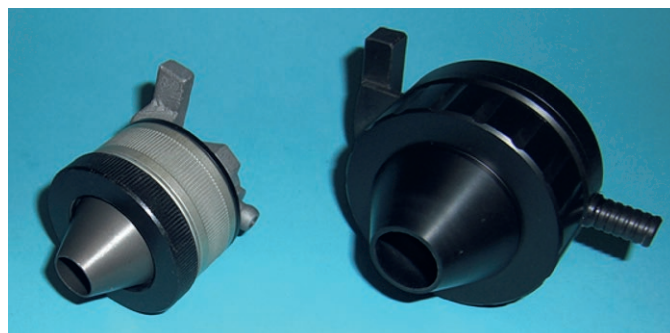
Fig. 2. GSP20 prototype sampling head (on right) for collecting the R dust fraction shown alongside the GSP10. Bild 2. Prototyp Probennahmekopf GSP20 (r.) zur Sammlung der E-Staubfraktion im Vergleich zu GSP10. Photo/Foto: IFA
