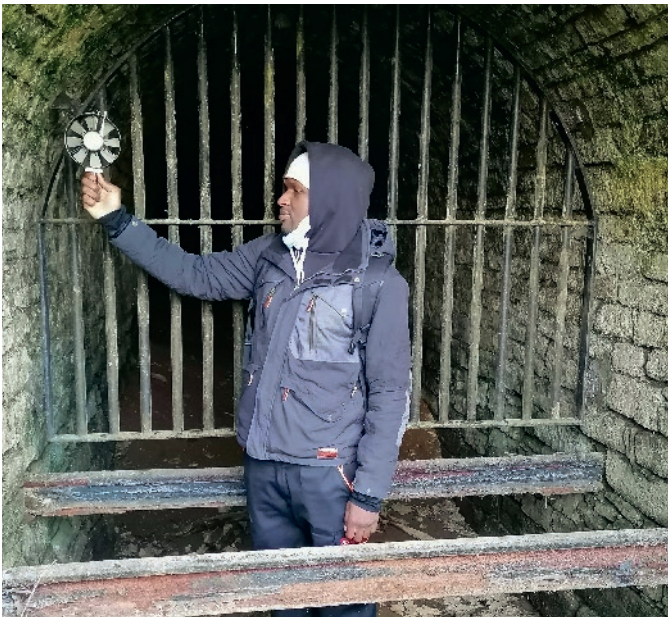
Fig. 2. Anemometer measurement in a tunnel. Bild 2. Anemometermessung an einer Rösche. Photo/Foto: Weyer
