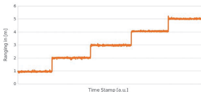
Fig. 5. Ranging in defined distances between the person and the monorail. Bild 5. Ranging in definierten Abständen zwischen der Person und der EHB. Source/Quelle: SPHEROID
