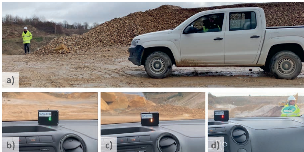
Fig. 3. a) A possible collision between the vehicle and the person with the (b) green LED in the hazard-free area and (c) yellow LED in the warning area and (d) red LED in the hazardous area. Bild 3. a) Eine mögliche Kollision zwischen dem Fahrzeug und der Person mit dem (b) grünen LED im gefahrlosen Bereich, (c) mit dem gelben LED im Warnbereich und (d) roten LED im gefährlichen Bereich. Photos/Fotos: SPHEROID
