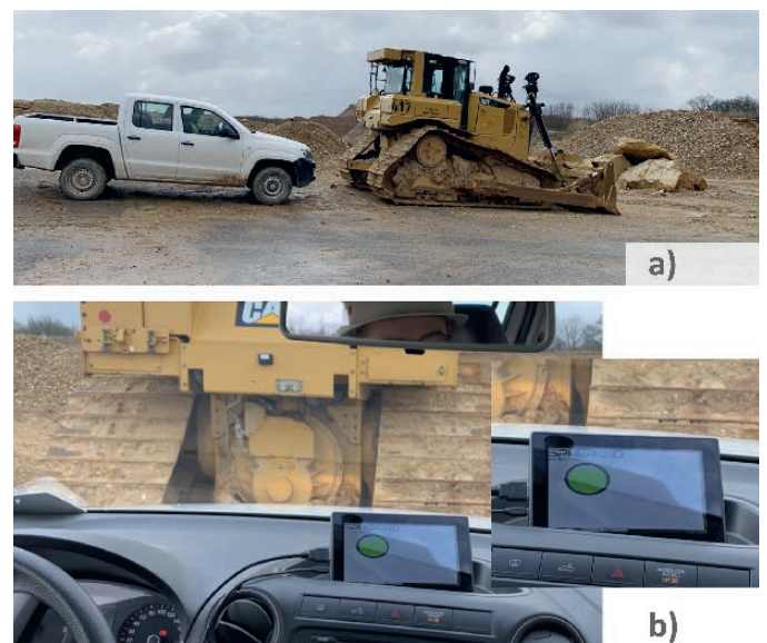
Fig. 8. a) A bulldozer without any blocking object and an overtaking vehicle behind it with, b) a green indicator on the driver's display. Bild 8. a) Eine Planierraupe ohne Hindernis und mit einem überholenden Fahrzeug hinten, b) ein grünes Warnsignal auf dem Display des Fahrers. Photos/Fotos: SPHEROID
