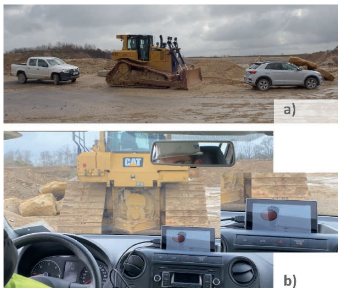
Fig. 7. a) A bulldozer blocked by a vehicle in front and a vehicle ready to overtake behind it, b) a red warning signal on the driver's display. Bild 7. a) Eine Planierraupe blockiert von einem vorausfahrenden Fahrzeug und einem überholenden Fahrzeug hinten, b) ein rotes Warnsignal auf dem Display des Fahrers. Photos/Fotos: SPHEROID
