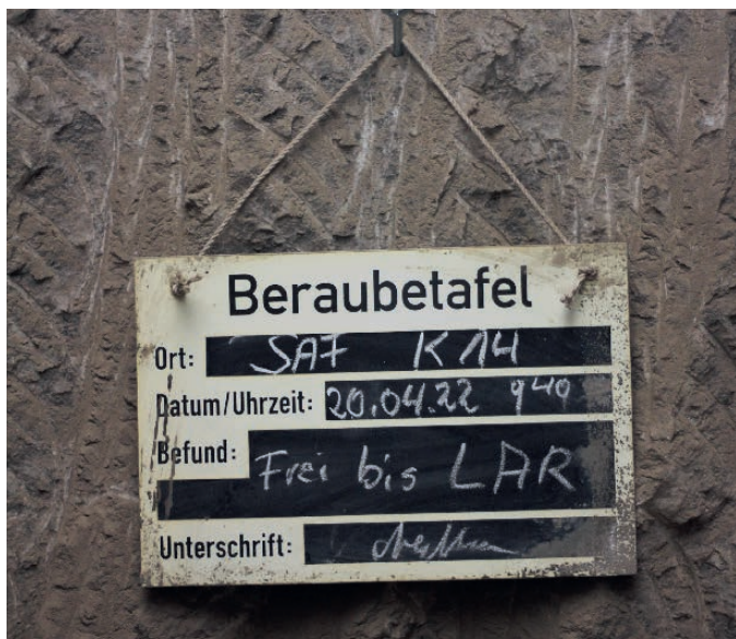
Fig. 5. A scaling board for the release of the backfill cavity. Bild 5. Eine Beraubetafel zur Freigabe der zu versetzenden Kammer (LAR: Letzte Ankerreihe). Photo/Foto: GTS
